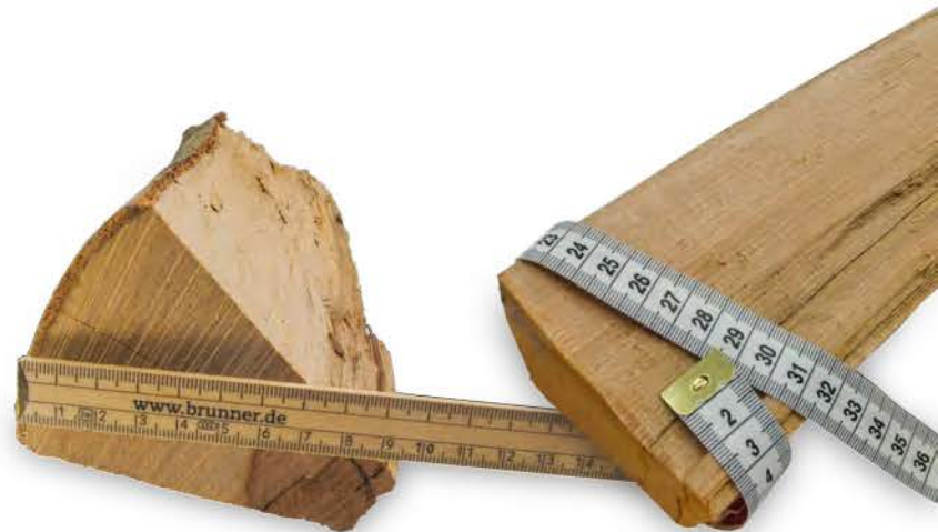
Een houtbloktrek van 25 cm komt overeen met een houtblokdiameter van ongeveer 9 cm
