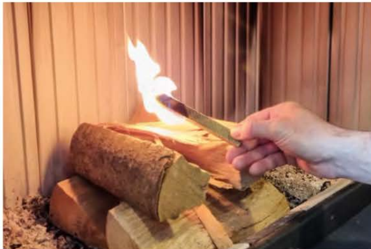
Controleer of er voldoende negatieve schoorsteendruk is ("Trektest")
