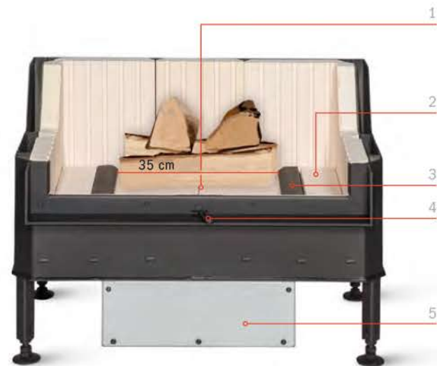
1 Verbrandingskamerbodem met geïntegreerde vuurkorf 2 Bodemstenen zijkant 3 zijdelingse verbrandingsluchtinlaat (primaire lucht) 4 Bedieningselement voor verbrandingsluchtinstelling ("luchtschuif") 5. Aansluitdoos voor buitenluchtaansluiting en luchtklep servomotor voor verbrandingsregeling
